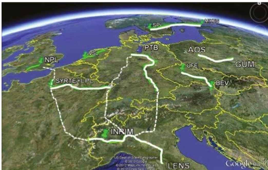
Фигура 1. Светлина и разпределение на времето: влакнесто-оптични връзки в Европа. Непрекъснати линии: съществуващи оптични връзки. Пунктирани линии: разширения, изграждани в момента [4]
