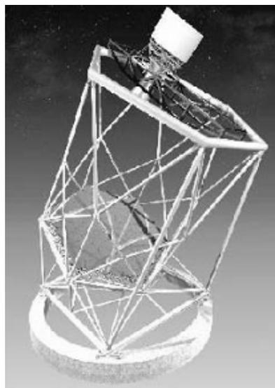
Фиг. 2. Големият южно-африкански телескоп (SALT). Виждат се сегментираното главно огледало, следящата система и инструменталният отсек.
