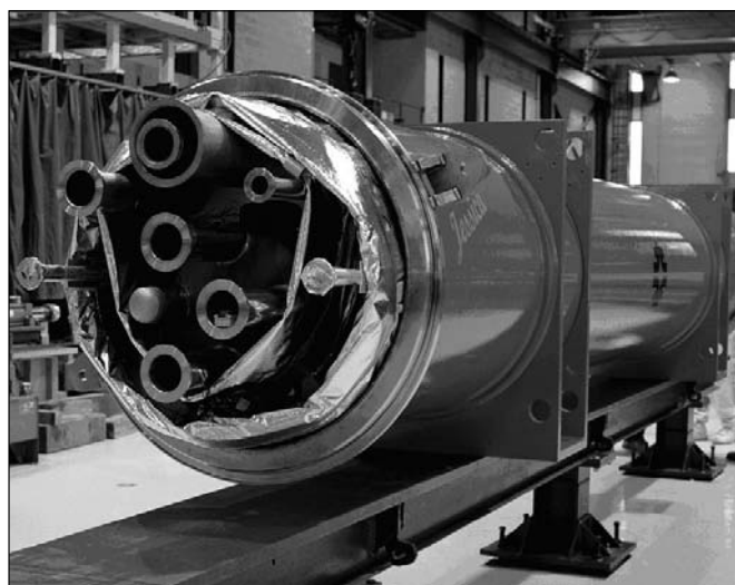
Фиг. 2. Свръхпроводящият диполен магнит на LHC
