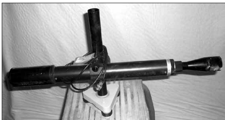
Лазерен визир на теодолитна стойка с колона. В държателя е закрепен хелий-неонов лазер с вътрешни огледала. 1971 г. България
