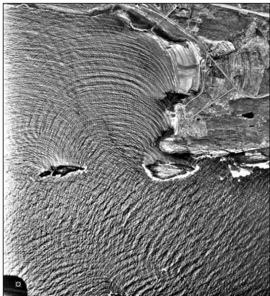
Фиг. 7. Изкривяване на фронта на вълната под влияние на променливата дълбочина на морското дъно и на малки препятствия. (аерофотография на морето в близост до Киберг, Финландия)
