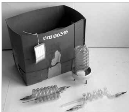
Импулсни лампи за възбуждане на първия български рубинов лазер.
