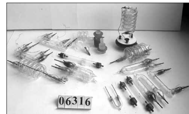
Импулсни лампи за възбуждане на българския рубинов лазер (1961-1963 г.)
