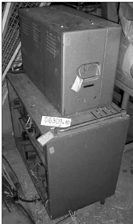
Стабилизиран токоизправител, служил за хранване на първите български лазери. Изработен в лаборатория за електронна научна апаратура при ФФ на БАН. Използвана за хранване на първия хелий-натриев и рубинов лазери.
