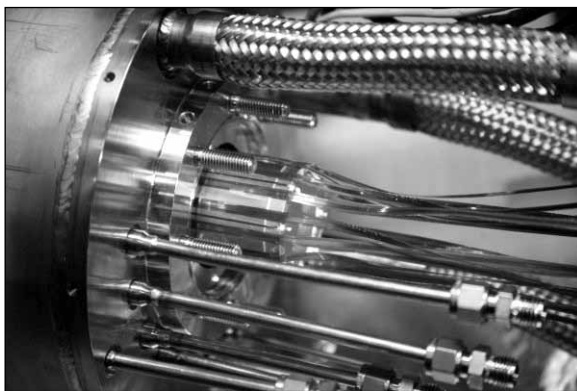
Фиг. 1. „Капанът” за антиводородни атоми в CERN. В този капан позитрони и антипротони се комбинират, за да формират антиводородни атоми
