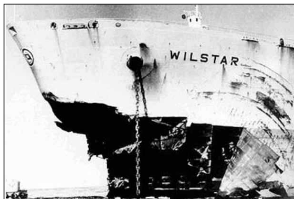
Фиг. 5. Поражения нанесени от гигантска вълна на норвежския танкер „Уилстар“ през 1974 г.
