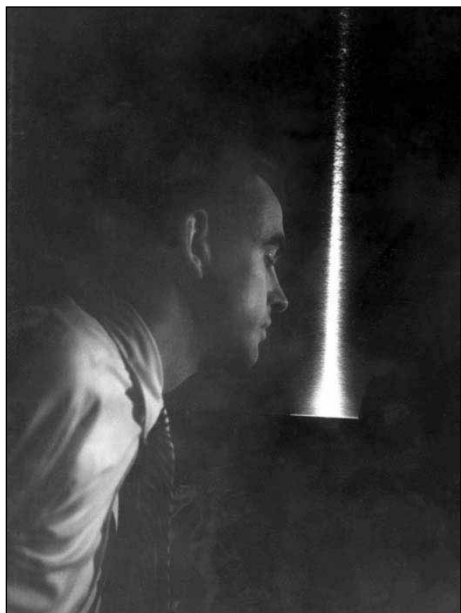
Фиг. 1. Лъч във формата на заострен молив се издига от първия рубинов лазер построен в лабораториите Бел и очертава грапава вертикална повърхност докато Доналд Нелсън я наблюдава през 1960 год.
