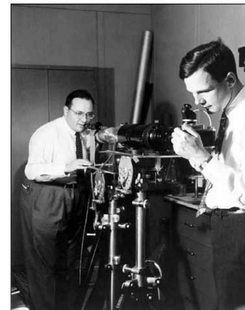
Фиг. 2. Артър Шавлов и Джофри Гарет (десният) юстират рубиновия лазер на лабораториите Бел, за да получат интерференчна картина на Фабри-Перо, с цел да измерят ширината на спектралните линии на изхода.
