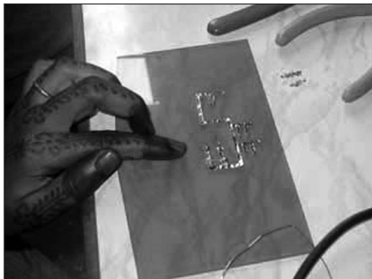
Фиг. 4. Печатна верига, оформена от адхезивно медно фолио с виниловата резачка и залепена върху пластмасова платка, изрязана по размер от 3D фрезата
