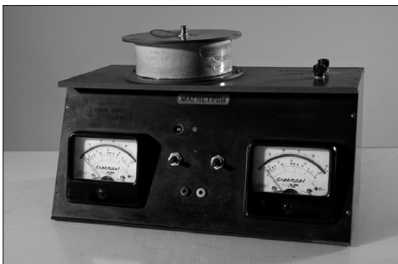
Фиг. 5. Лабораторна постановка за определяне на специфичния заряд на електрона
