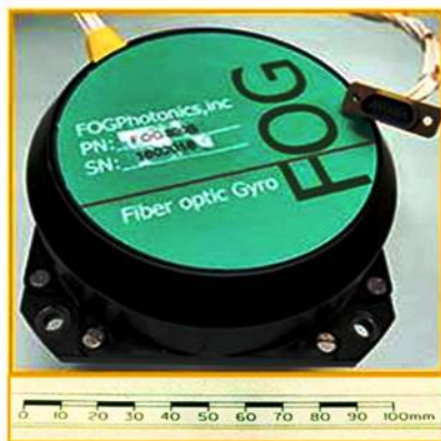
Фигура 4. Характерен външен вид и размери на влакнесто-оптичен жирокоп за авиационни навигационни системи
