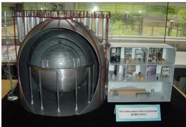
Фигура 2. Макет на неутринния детектор Borexino
