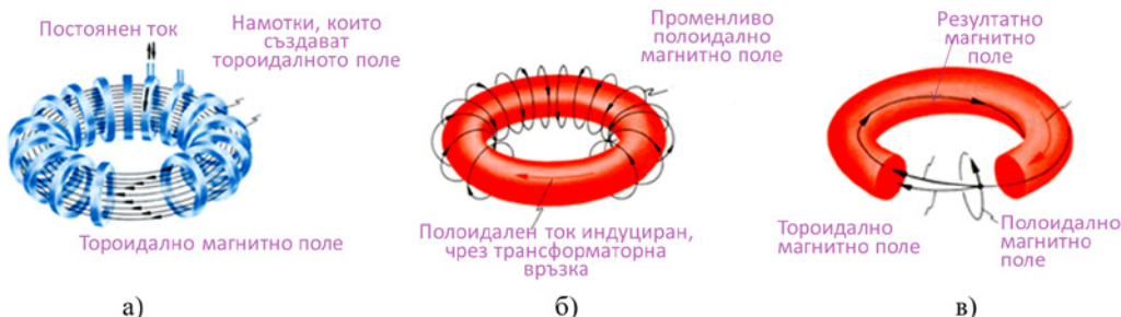
Фигура 4. Конфигурация на магнитното поле в тора
