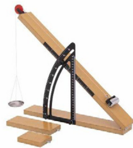
Фигура 5. Преместваема експериментална установка, използвана за моделиране на наклонена равнина, източник: интернет
