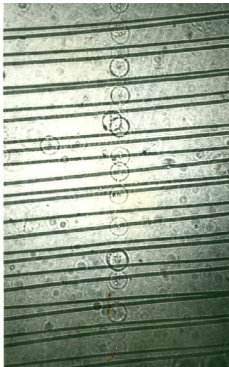
Фигура 9. Възстановени 30 \mu\text{m} изображения от Габорова холограма на 10 atm водородна стримерна камера; кръгчетата около тях са ударните вълни, а хоризонталните линии са изображенията на 50 \mu\text{m} волфрамови камерни електроди
