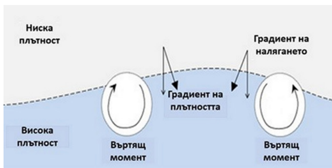
Фигура 3. Схема на механизма на нестабилността на Рейли-Тейлър
