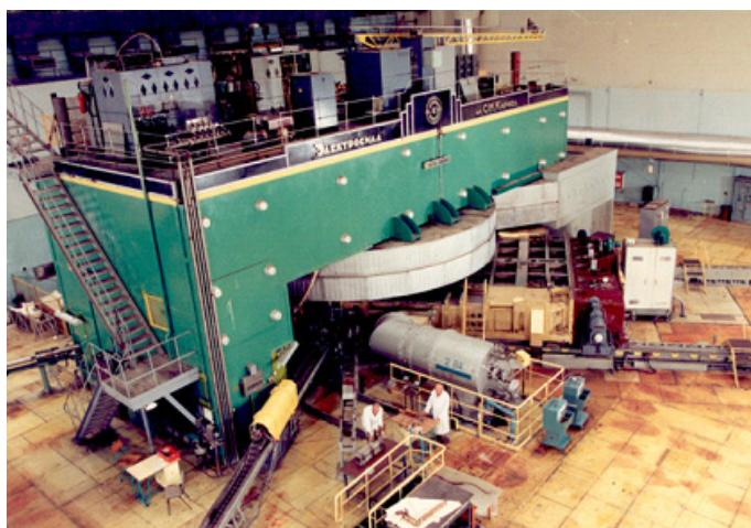
*Фиг. 1. Първият ускорител построен в Дубна – синхроциклон, ускоряващ протони до максимална енергия 680 MeV. Синхроциклонът започва работа през 1949 г. През 1979 – 1984 г. е реконструиран във фазotron с пространствена вариация на магнитното поле. Вътрешен ток на ускорените протони 10 KA, ток на изведения спон 4 KA.*
