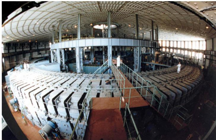
Фиг. 2. Синхрофазотронът, ускоряващ протони до максимална енергия 10 GeV. Ускорителят е построен в Дубна под ръководството на акад. В. И. Векслер и започва работа през 1957 г. Интензивността на ускорения протонен сноп е  $5 \cdot 10^{12} p/cycle$ . В момента синхрофазотронът ускорява тежки иони до максимална енергия 4 GeV/A.
