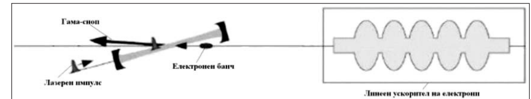
Фиг. 5. Генериране на интензивен \gamma -сноп при обратно Комптоново разсейване на лазерни импулси от релативистки електронен сноп
