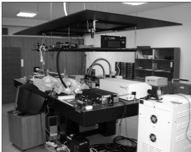
Система, която позволява генериране на суб-40-фемтосекундни импулси с честота на повторение от 1 kHz, при енергия на единичен импулс от над 3.5 mJ
