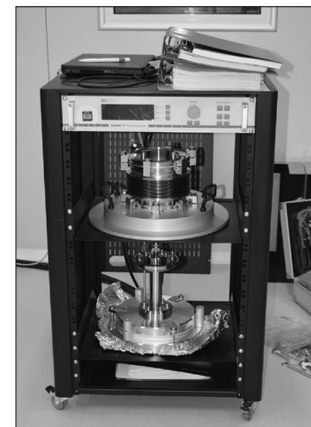
Висококачествен генератор за плазмено-стимулирано отлагане на атомни слоеве
