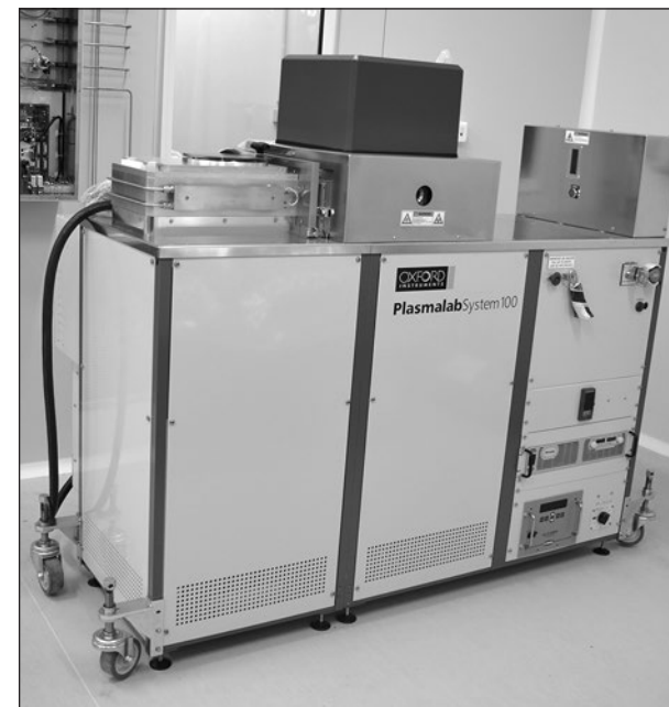
Апаратура за отлагане на графен и въглеродни нанотръбички: „Nanofab Plasmalab System 100”
