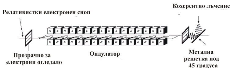
Фигура 2. Принцип на работа на лазер със свободни електрони
