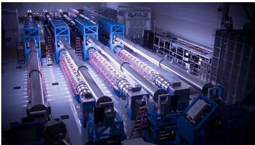
Фигура 2. Усилвателите за OMEGA-EP на Университета в Рочестър, използващи лампи за напompване, стимулиращи по-силно излъчване на лазери с голяма енергия в импулса, генериран за много кратко време
