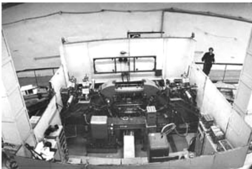
Рис. 5. Протонният ускорител НАП - М в Новосибирск, на който е осъществено за първи път електронно охлаждане на снопове частици
