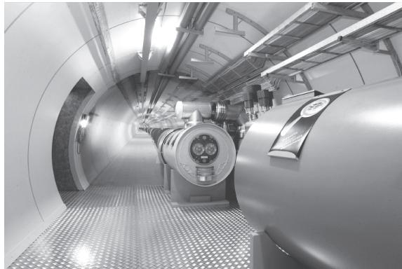
*Фиг. 3. Пълномащабен модел на тунела на новия ускорител LHC в CERN. Вижда се самият тунел и един от свръхпроводящите 10-метрови диполни магнити, които ще удържат протоните с енергия 7 TeV върху орбитата им с форма на окръжност с дължина 27 км.*
