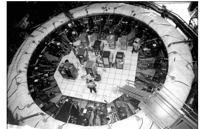
Фиг. 7. Мюонният натрупващ пръстен на експеримента (g-2) в Брукхайвън
