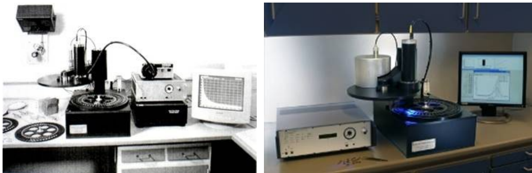
Фигура 8. Четец за термо- и оптически стимулирана луминесценция, модел Risø TL/OSL-DA-20
