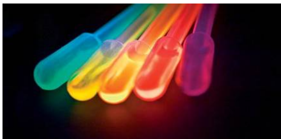
Фигура 2. Капсули от полимер с диспергирани в тях квантови точки от еднакъв материал, но с различни за различните капсули размери. Те излъчват от синя до червена светлина в зависимост от размера на квантовите точки
