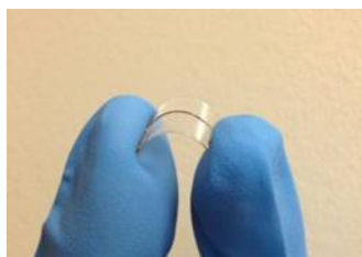
Фигура 14. Гъвкави суперкондензатори на базата на графен
