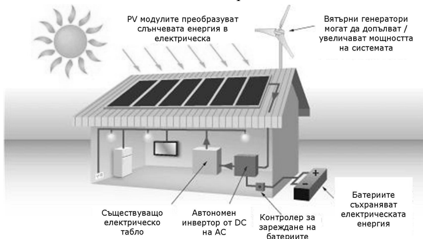
Фотоволтаична система за производство на електрическа енергия
