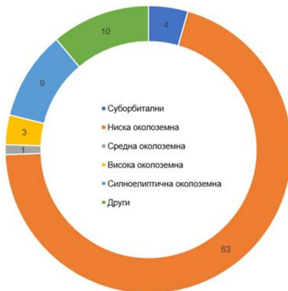
Фигура 5. Разпределение на КТ по области в околоземното пространство. За граница на суборбиталния полет е приет височина при апогей A < 300 km. Категорията „други“ присъства за пълнота и включва КТ, които не са в околоземна орбита. При тях има три случая: КТ в орбита около Слънцето; КТ в орбита около точка на Лагранж на системата Земя-Луна, както и неподвижни КТ на повърхността на Луната
