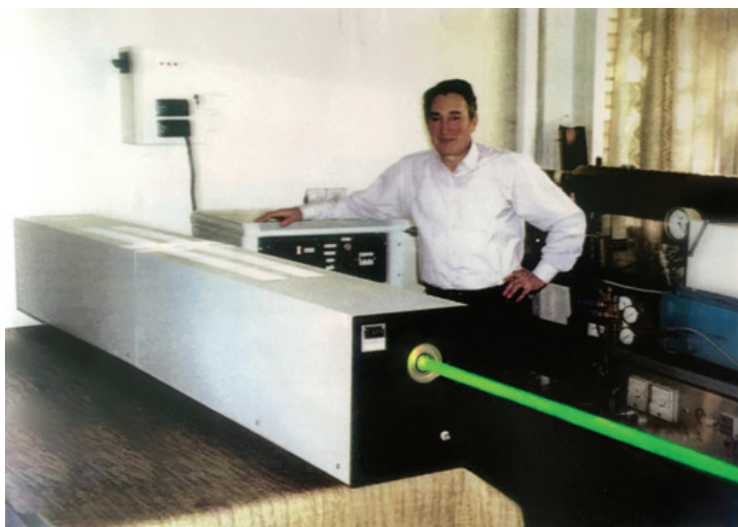
Фигура 6. Проф. Никола Съботинов показва в действие лазер с пари на меден бромид със средна мощност 40 W
