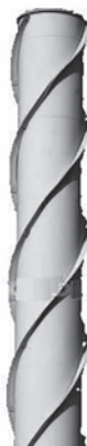
Фигура 6. Спирални ребра, препятстващи образуването на вихрова улица на Карман при про- мишлен комин
