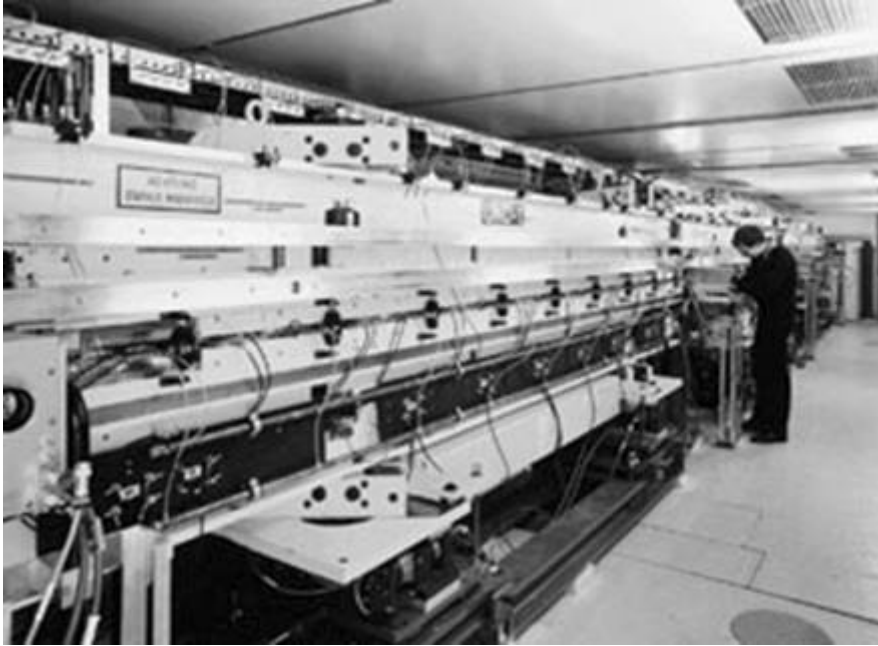
Фиг. 3. Ондулаторът на ТТФ лазер със свободни електрони.
