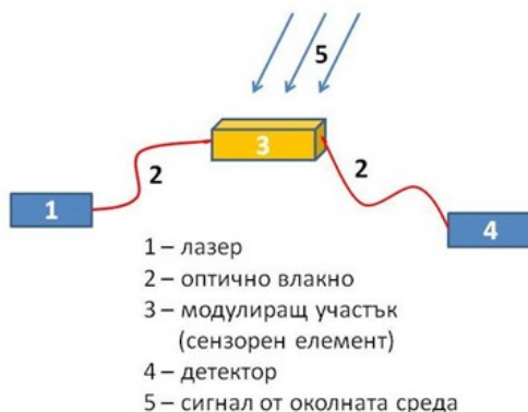
Фигура 5. Блок-схема на влакнестооптичен сензор
