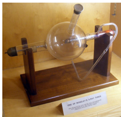
Фигура 4. Рентгенова тръба, използвана в експериментите на Мозли (източник: Wikipedia)
