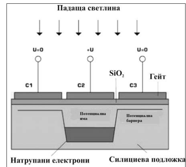
Принципно устройство на пиксел на CCD-матрица
