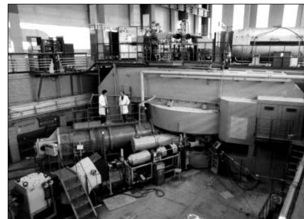
Фиг. 5. Тежкыйонният циклотрон У-400 на Лабораторията за ядрени реакции на ОИЯИ, Дубна
