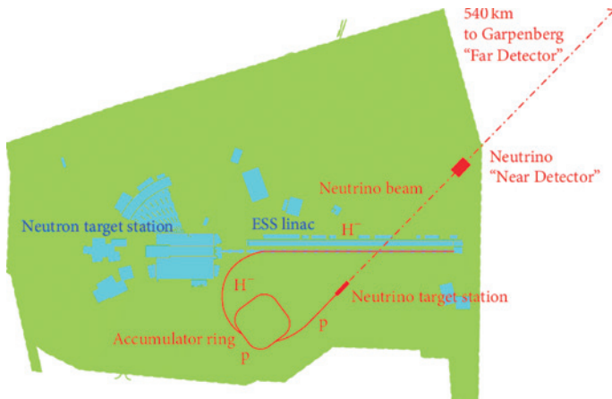
Фигура 1. Схема на проекта ESSnuSB . Показани са протонният линеен ускорител, акумулаторният пръстен, мишената и позицията на близкия детектор. Далечният детектор не се вижда, той се намира на разстояние около 500 km в посока север, както е указано с червената стрелка
